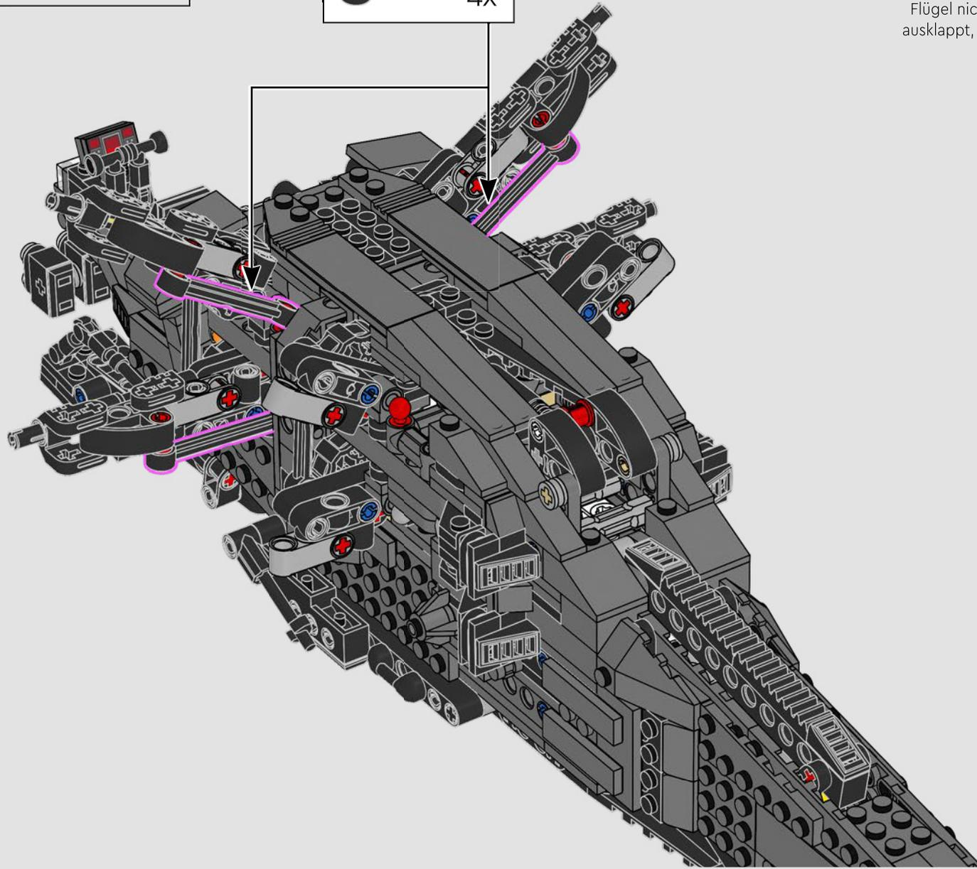
Die Spurstangen, die mit dem Kern des Modells verbunden sind, sorgen dafür, dass die schlagenden Flügel nicht von dem Mechanismus, der die Flügel ausklappt, nach vorn oder hinten gezogen werden.
